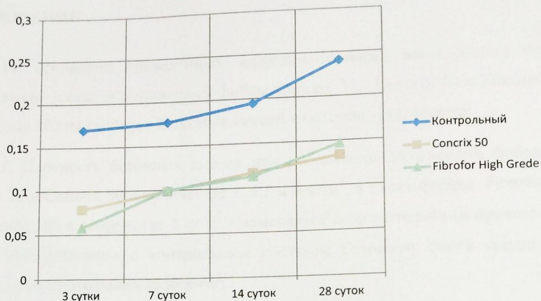
Рисунок 2.6 – Относительные деформации усадки бетона в возрасте 3, 7, 14 и 28 суток
