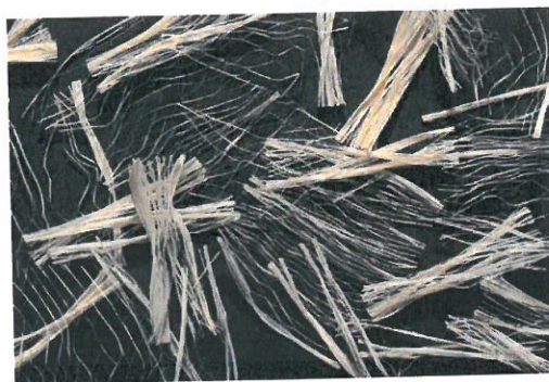
Рисунок 1 – Фибриллированные микроволокна Fibrofor High Grade собранные в пучки
