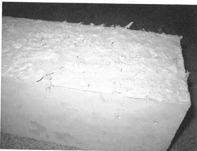
Рисунок 7 – Образец дисперсноармированного микроволокном бетона
