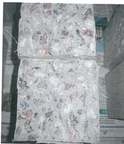
Рисунок 4 – Образцы бетона 10×10×40 см после испытаний на растяжение при изгибе
