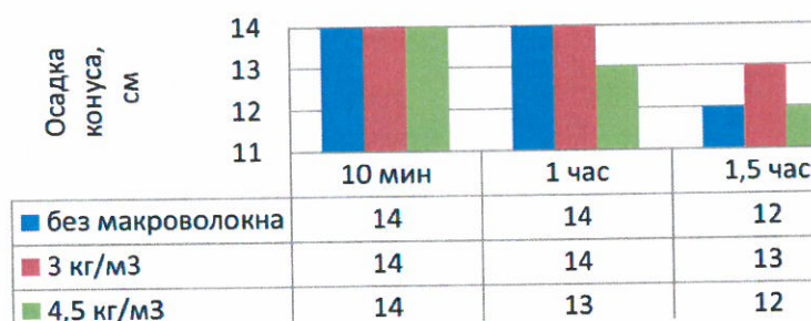
Рисунок 5 – Влияние расхода макроволокна на удобоукладываемость и сохраняемость бетонной смеси
